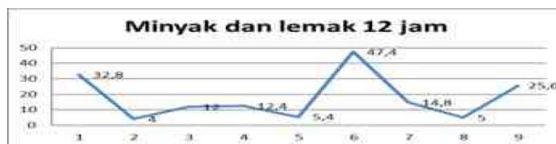
**Gambar 3. Grafik Aerasi Hasil Uji Minyak/Lemak Waktu Detensi 12 Jam**
