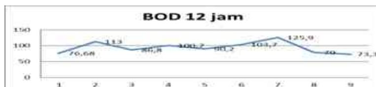
**Gambar 9. Grafik Sedimentasi Hasil Uji BOD Waktu Detensi 12 Jam**
